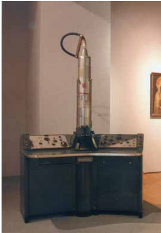
Primeiro microscópio electrónico em Portugal (década de 1950), oferecido pela Fundação Calouste Gulbenkian à Faculdade de Medicina, um RCA da série EMU 3 que permite observações directas com ampliações de 1.400 a 30.000 x e ampliações fotográficas de 200.000 x (Foto: Nina Szielasko).
